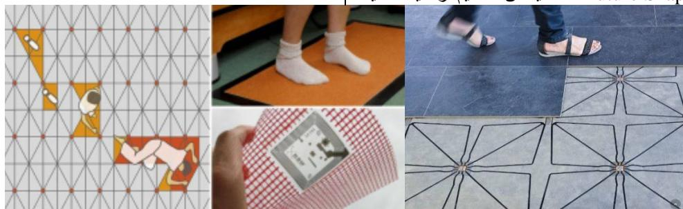
صور رقم (6) توضح الأرضيات الذكية التي تعطي تنبيها عند السقوط عليها
