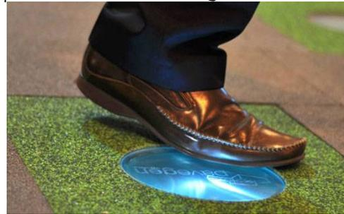
هذه التقنية، بشكل أساسي عبارة عن نظام أرضيات قابل للتعديل ومتعدد المهام، مزود بجهاز بث لاسلكي، مما يسمح بالتقاط البيانات من كل بلاطة، إضافة إلى مولدات تقوم باستخلاص الطاقة الحركية من حركة المشي (صورة رقم 2) .
