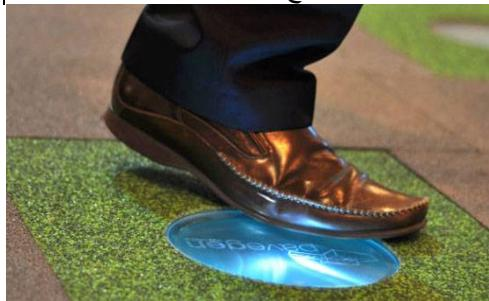
هذه التقنية، بشكل أساسي عبارة عن نظام أرضيات قابل للتعديل ومتعدد المهام، مزود بجهاز بث لاسلكي، مما يسمح بالنقل بين البيانات من كل بلاطة، إضافة إلى مولدات تقوم باستخدام الطاقة الحرارية من حركة المشي (صورة رقم 2).
