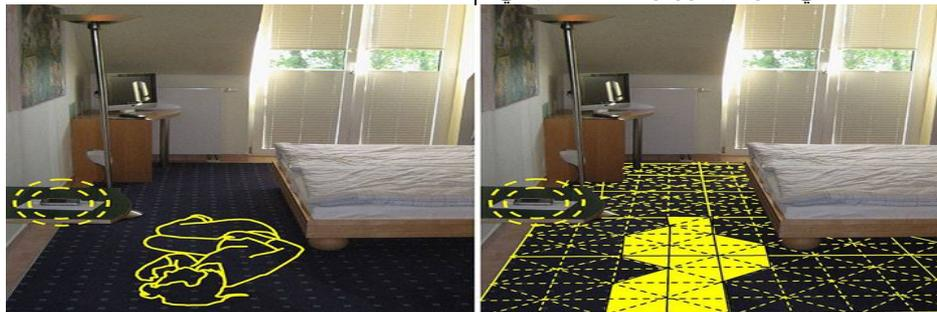
صور رقم (7) توضح الأرضيات الذكية التي تعطي تنبيهها عند السقوط عليها
